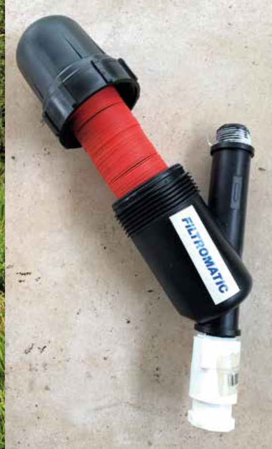
Ejemplo de un filtro de anillo, que es económico y fácil de desarmar y limpiar.
